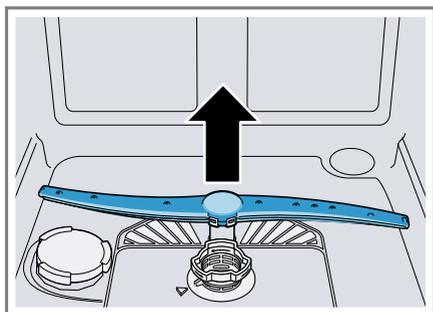
3. Sous l'eau courante, assurez-vous que les buses de sortie des bras d'aspersion sont dégagées et éliminez les corps étrangers au besoin.
