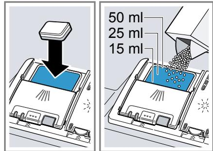
Une pastille suffit, le cas échéant. Une pastille suffit, le cas échéant. Déposez la pastille en diagonale. Si vous utilisez du détergent en poudre ou liquide, observez les indications de dosage du fabricant et la graduation du dosage du compartiment à détergent. 20 à 25 ml de détergent suffisent pour la vaisselle à souillure normale. Si la vaisselle est peu sale, une quantité de détergent légèrement inférieure à celle indiquée suffira habituellement.
